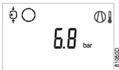
Основное окно с сообщением о защитном останове, температура на выходе компрессорного элемента
