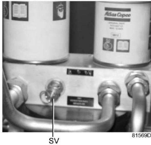
Предохранительный клапан резервуара маслоотделителя
