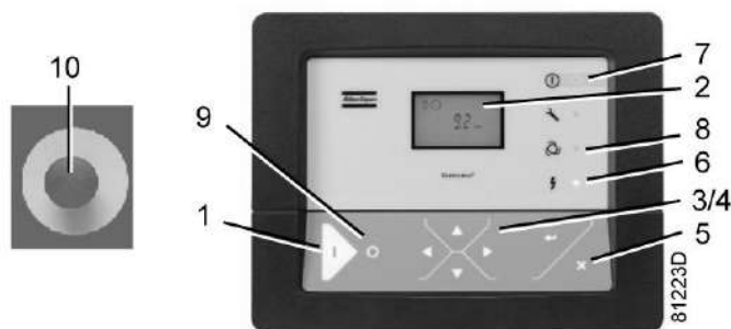
Панель управления контроллера Elektronikon®
