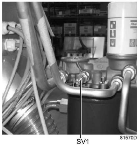
Предохранительный клапан резервуара маслоотделителя
