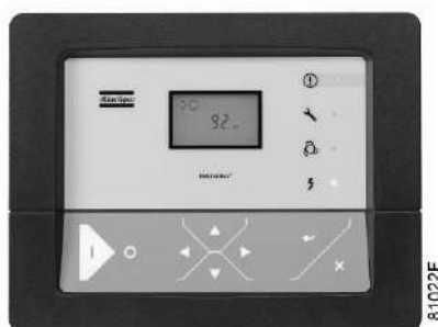
Панель управления контроллера Elektronikon®
