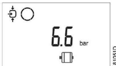
Основной экран с сообщением об аварийном останове, перегрузка двигателя
