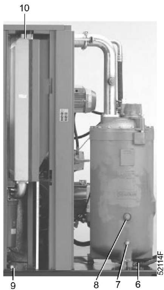
Заглушки вентиляционных, заливных и сливных отверстий на компрессорах с воздушным охлаждением с GA 200 по GA 315
