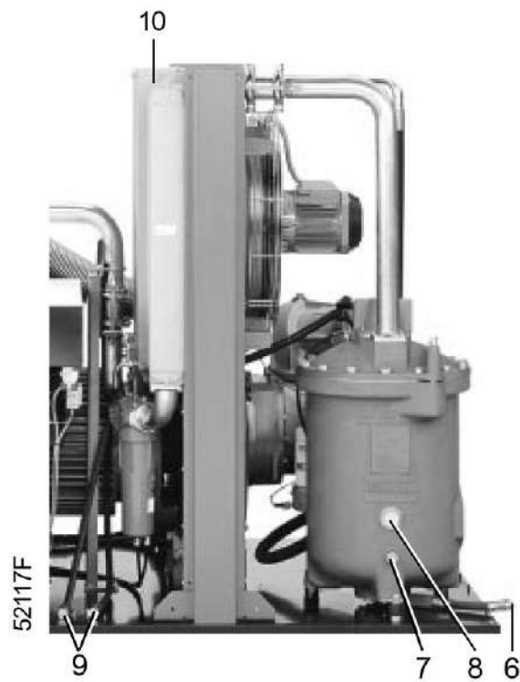
Заглушки вентиляционных, заливных и сливных отверстий на компрессорах с воздушным охлаждением с GA 90 по GA 160 и с GA 132 VSD по GA 315 VSD
