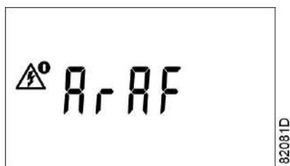
Автоматический перезапуск после исчезновения напряжения в электросети
