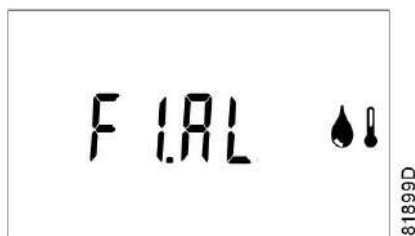
Выбрана фиксированная уставка аварийного сигнала
