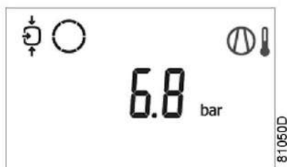
Основной экран с сообщением об аварийном останове, температура на выходе компрессорного элемента
