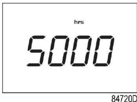
В приведенном примере на экране отображается используемая единица измерения <hrs> и значение <5000>: наработка модуля контроллера составляет 5000 часов.
