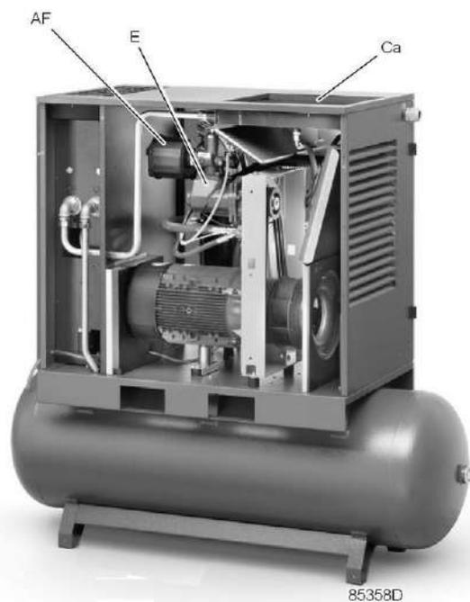
Вид сзади без дверцы, G 18 Full-Feature для установки на резервуаре
