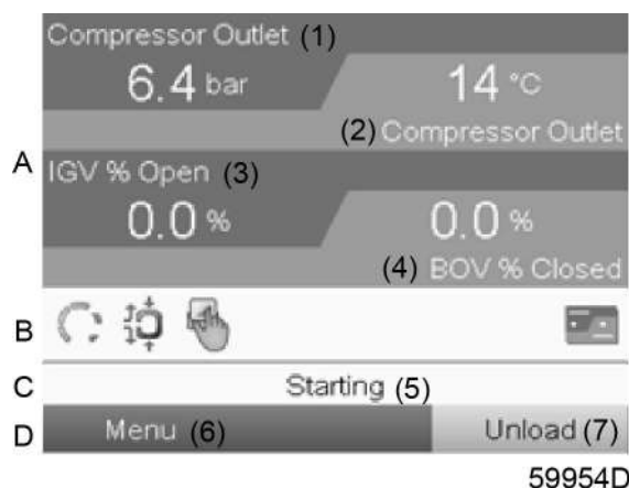
Типовой Основной экран компрессора (четыре линии значений)
