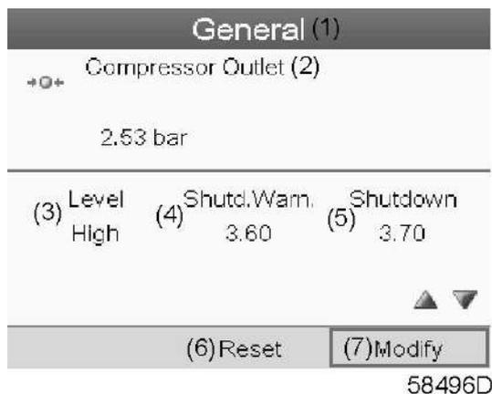
*Типовой пример экрана с сигналом*
