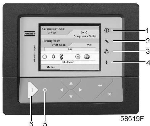
Когда горит светодиод автоматического управления (3), регулятор Elektronikon находится в режиме автоматического управления компрессором: частота вращения постоянно будет изменяться, чтобы производительность компрессора была согласована с потреблением сжатого воздуха, и компрессор будет запускаться и останавливаться, когда это необходимо.
